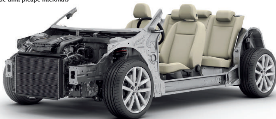
Plataforma modular MQV: base do novo Polo, do Virtus, de um SUV e de uma picape nacionais
