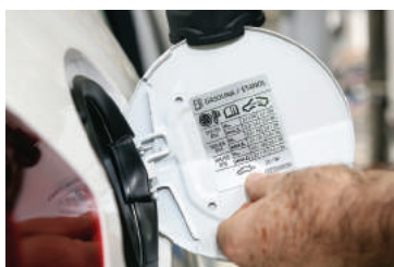
Célula 4.0 na fábrica da VW de São Bernardo do Campo: sensores indicam a etiqueta correta entre as 15 opções
