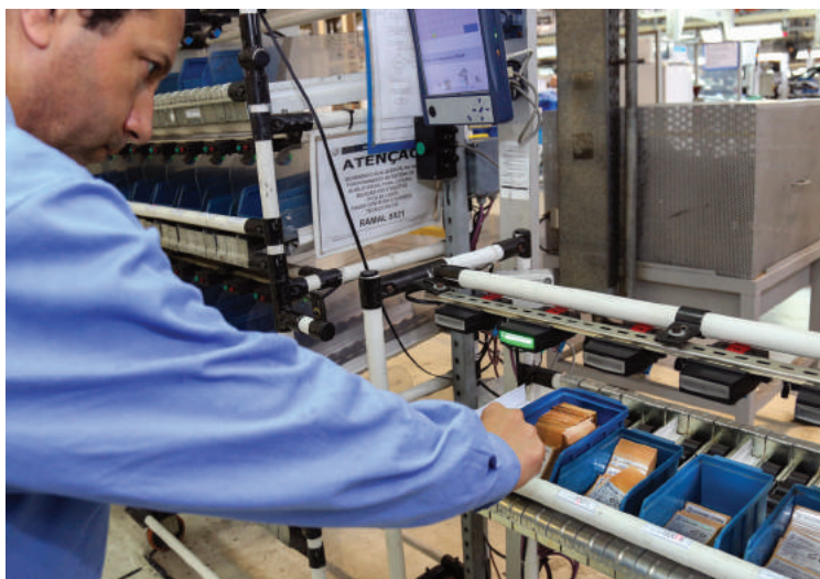
Célula 4.0 na fábrica da VW de São Bernardo do Campo: sensores indicam a etiqueta correta entre as 15 opções
