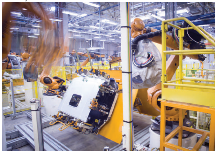
Produção de cabinas: 37 robôs e 60% de automação
