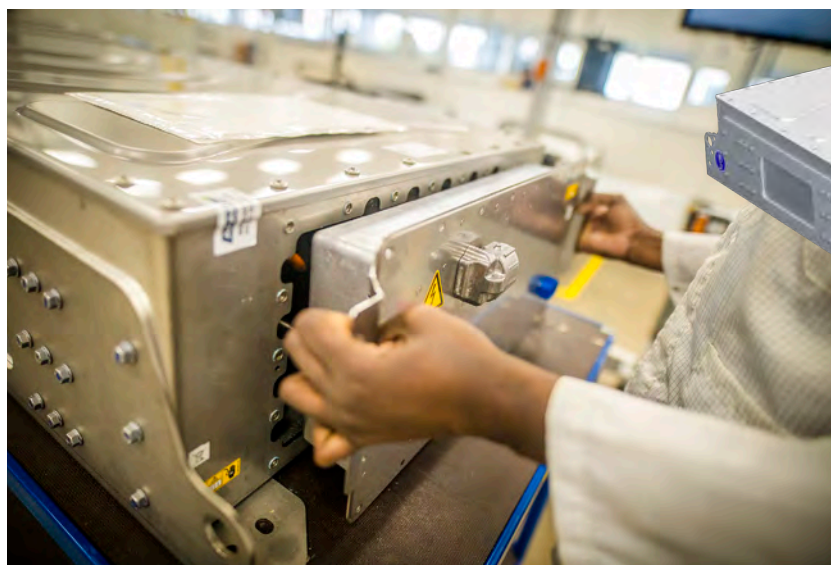
O sistema de bateria 9 AKM é montado em Piracicaba (SP) e tem alta eficiência energética. Pesa cerca de 600 kg e entrega 98 kWh
