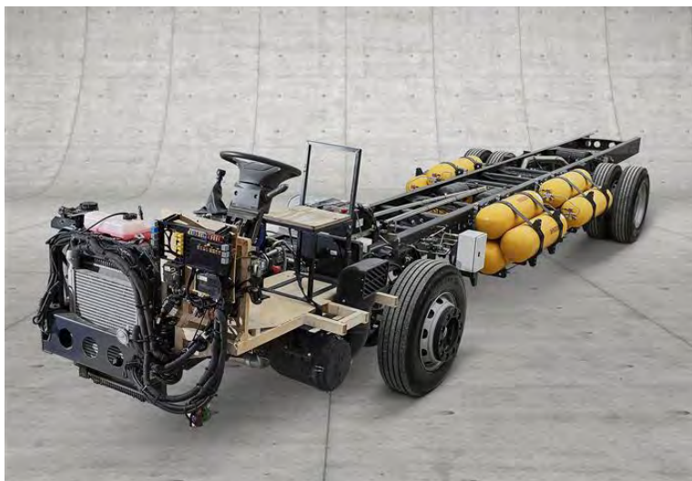
Chassi de ônibus a gás da Iveco com motor FPT: já em produção na Argentina com expectativa de vendas no Brasil.
