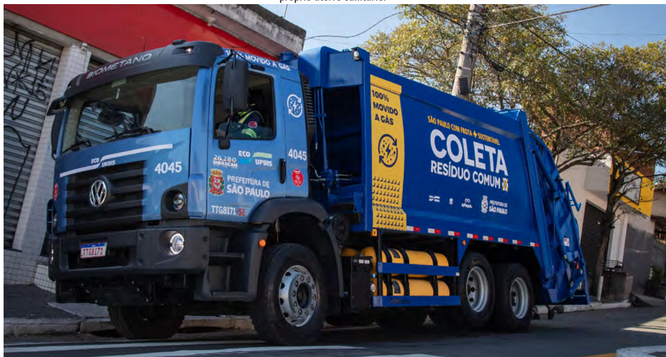
Caminhão Constellation a gás da VWCO: coletor de lixo pode ser abastecido com biometano gerado no próprio aterro sanitário.
