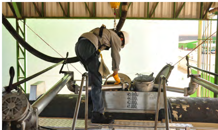
Produção de biodiesel: processo de transesterificação com adição de metanol.
