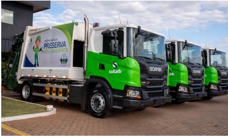
Caminhões a gás Scania para coleta de lixo: veículos transportam a matéria-prima para produção de biometano.
