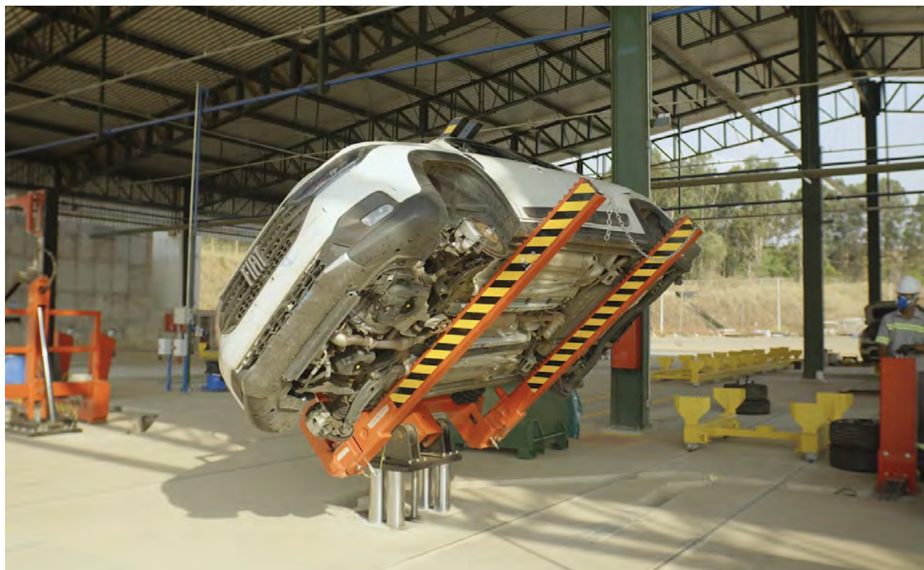
Carro em processo de desmontagem na Igar: sete subprodutos para reciclagem.
