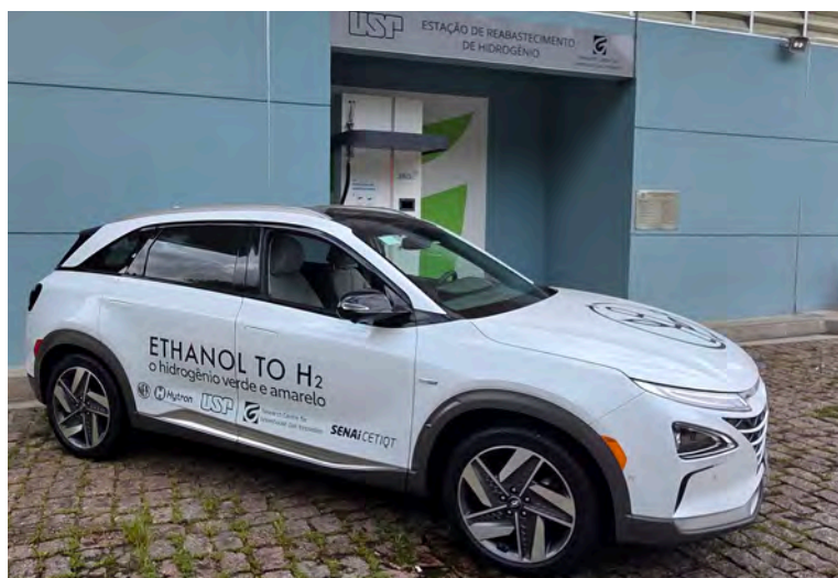
O Hyundai Nexu na estação da USP para abastecimento com hidrogênio extraído de etanol
