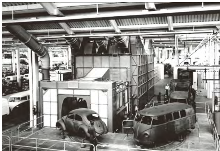
Início da aventura industrial: cabine de pintura da fábrica na Anchieta em seus primeiros anos de funcionamento, no fim dos anos 1950.
