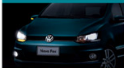
Cornering light - faróis de neblina com luz de conversão estática
