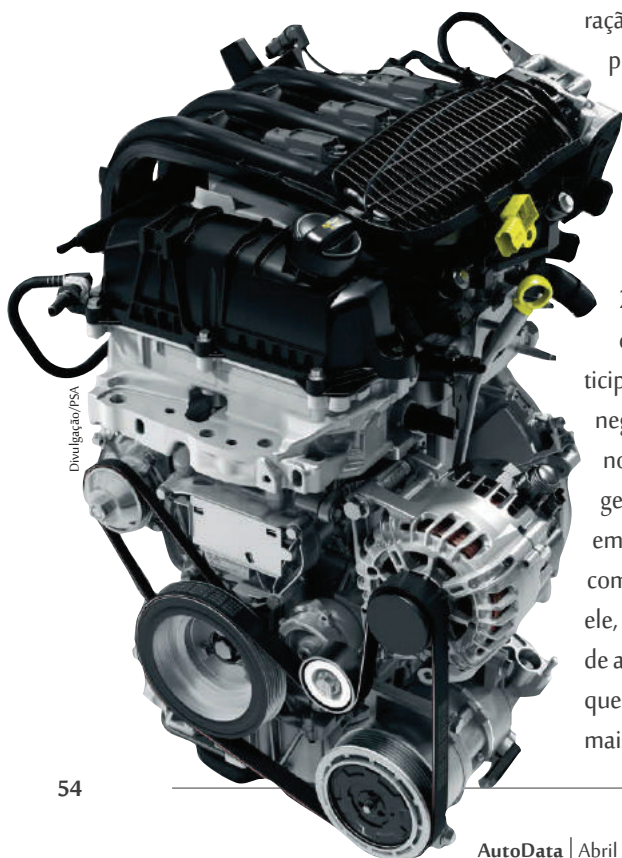
Motor PureTech 1.2 de três cilindros bicom-bustível
