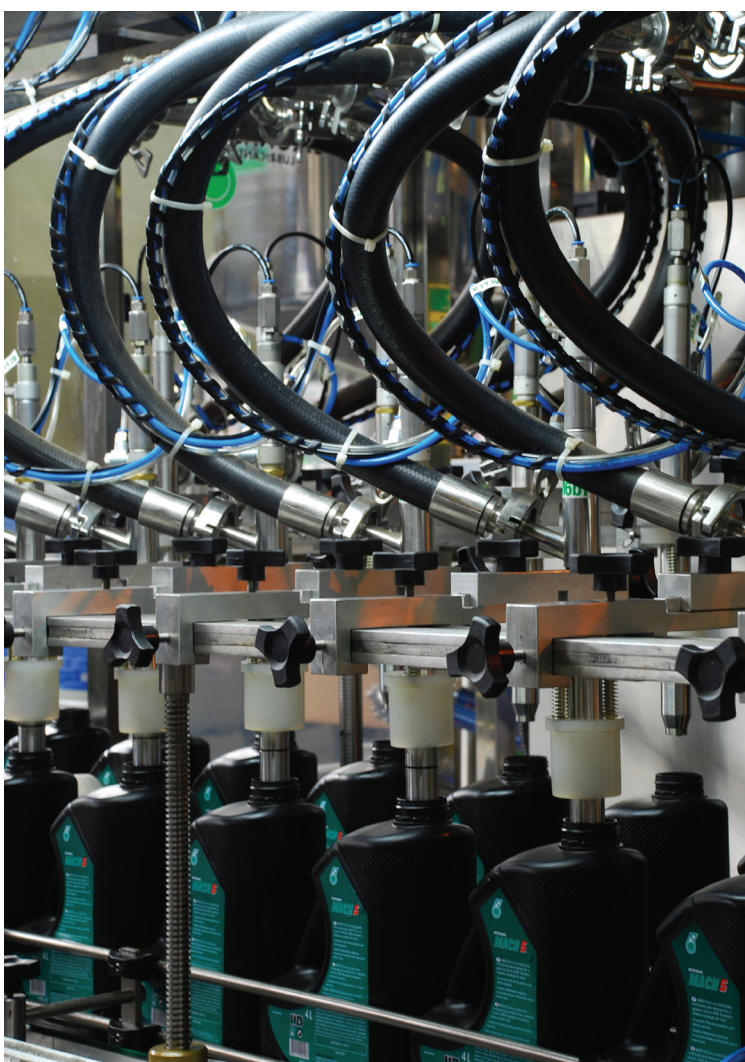
Na linha da Petronas máquinas envasam até 14 mil litros de lubrificantes por hora
