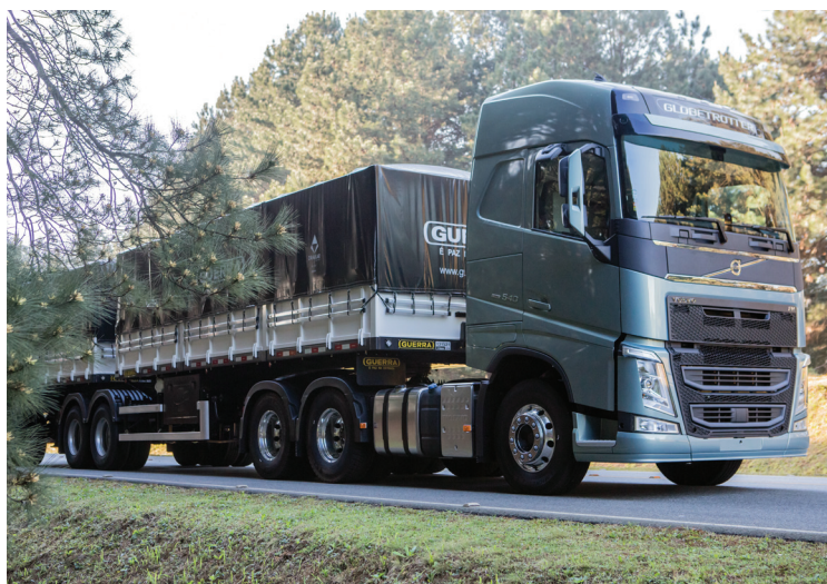
A Volvo cria sistema suspensor do segundo eixo motriz para modelo 6x4
